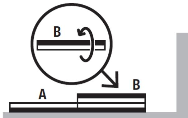
Отметьте место разрезания на плитке В.
